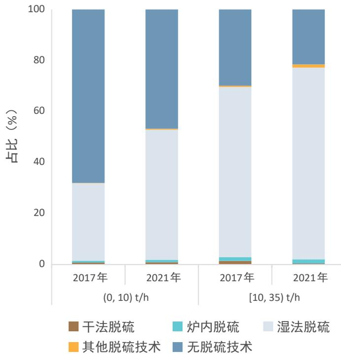
图 1-4 燃煤小锅炉二氧化硫污染控制技术类型变化情况
